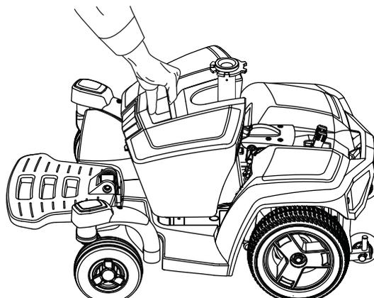
4. D'INSTALLER LE BÔTIER DE BATTERIE, SAISIR LA POIGNÉE DE LA BOÎTE DE LA BATTERIE ET DE L'INCLINAISON DE LA BOÎTE LÉGÈREMENT VERS L'AVANT.
